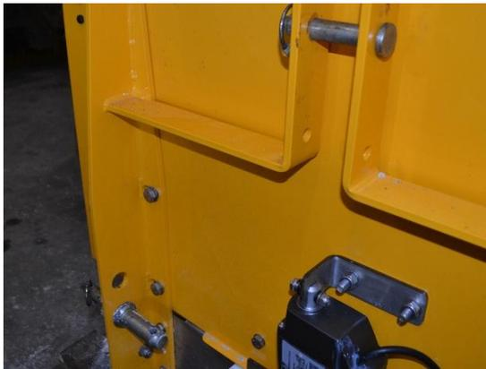
Bei den Anhebemodellen bitte beachten Sie dass Nagel und Splitter richtig installiert ist. Die Zugmaschine muss gestoppt werden.
