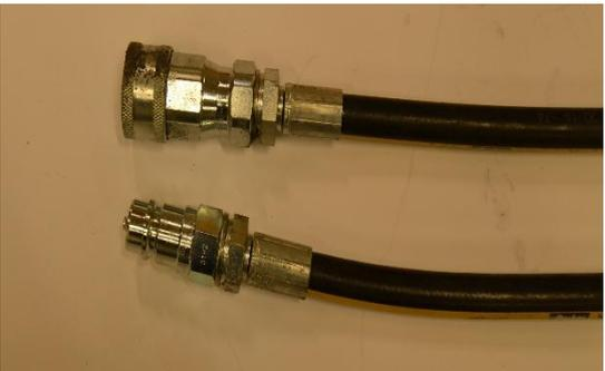
Seien Sie vorsichtig und wachsam bei der Montage. Die Zugmaschine muss gestoppt werden, weil die Hydraulik mit etwa 200 bar arbeitet, wenn aktiviert.
