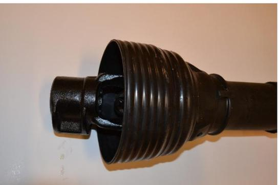
Bei Maschinen mit Zapfwelle muss die Zugmaschine gestoppt beim Montage werden. Kette des Schutzrohres muss montiert werden.
